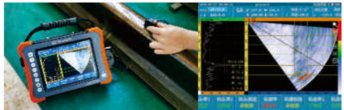
疑难试块轨底检测
