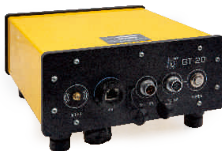
仪器后面板(WIFI天线, 有线网口, 电源及开关机接口)
