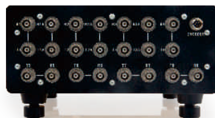
仪器前面板（探头面板），9个探伤用通道+1个校准通道+1个备用通道
