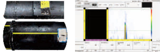
PE热熔管裂纹全聚焦检测结果图
