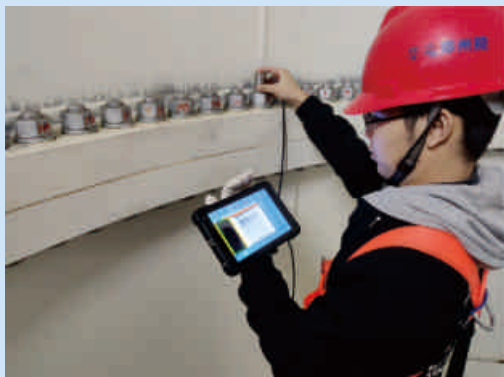
风电螺栓相控阵检测
