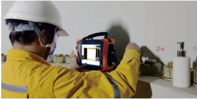
风电塔筒螺栓现场检测
